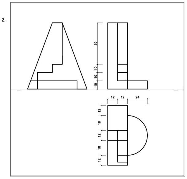
Dada la figura, dibujar las proyecciones ortogonales a una escala, acotándolas (planta, alzado y vista lateral derecha). Las medidas están expresadas en milímetros.
